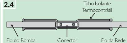
Aquecer começando do centro em direção as extremidades, certificando que não fiquem bolhas. Sua emenda estará completa quando o tubo estiver encolhido em torno da emenda e visualizar que nas extremidades o selante escorre do tubo.
