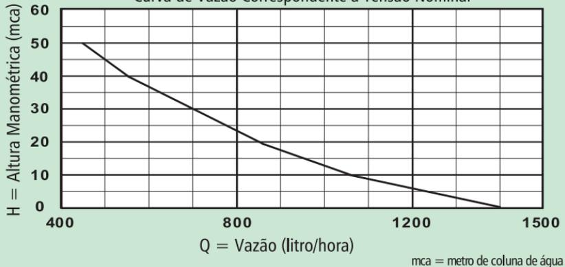
Obs.: A bomba permite uma variação de tensão nominal de  $\pm 5\%$ , porém com interferência na sua vazão.
