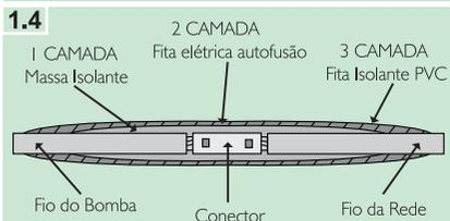
Detalhe em corte da emenda completa.
