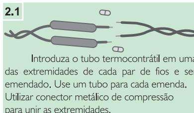
Introduza o tubo termocontrátil em uma das extremidades de cada par de fios e ser emendado. Use um tubo para cada emenda. Utilizar conector metálico de compressão para unir as extremidades.
