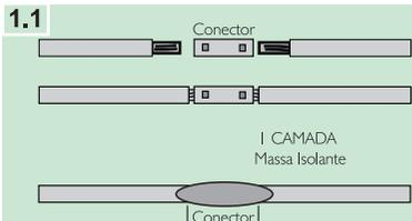
Utilizar conector metálico de compressão para unir as extremidades. Aplicar 1 camada de massa isolante.
