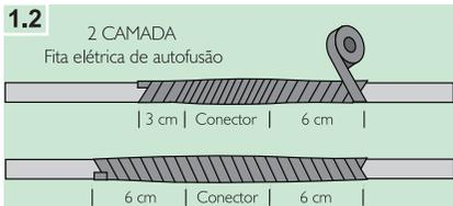
Aplicar 2 camadas com a fita elétrica de autofusão, tracionar a mesma de forma adequada.
