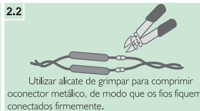
Utilizar alicate de grimpar para comprimir o conector metálico, de modo que os fios fiquem conectados firmemente.
