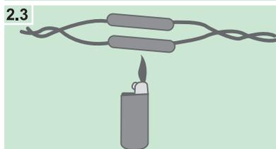
Centralizar o tubo termocontrátil sobre o conector metálico e aquecer com uma fonte de calor (soprador de ar quente ou isqueiro comum).
