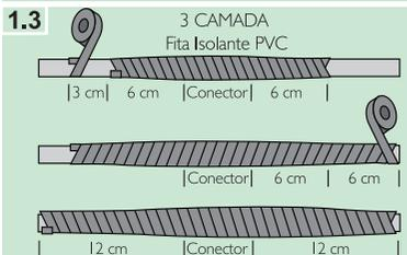
Aplicar 3 camadas com a fita isolante PVC, tracionar a mesma de forma adequada.
