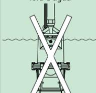
Bomba suspensa pelo cabo elétrico.
